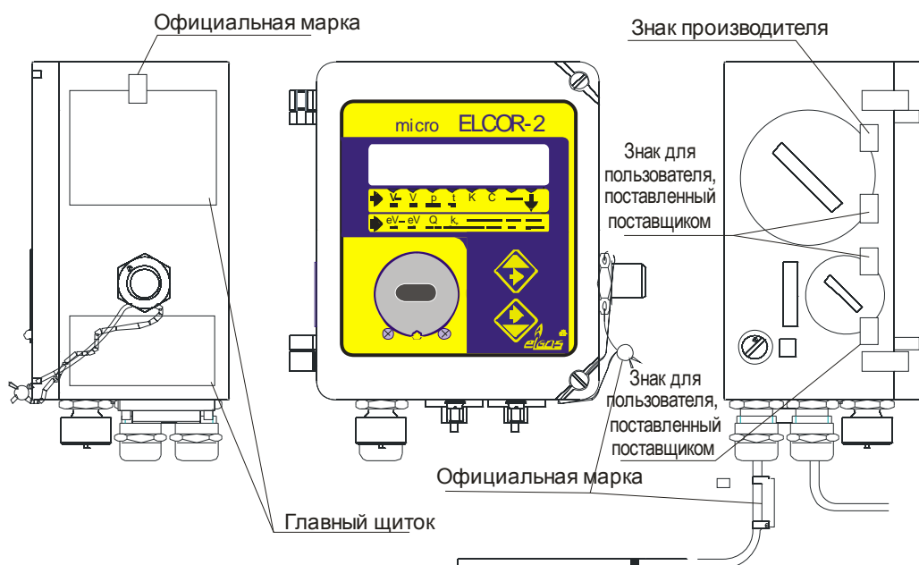
Рис. 16 Пример главного информационного щитка и знака производителя
